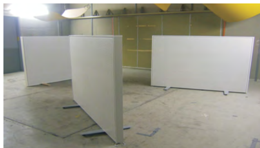
Foto: Anordnung der Elemente im Hallraum, Fraunhofer Institut für Bauphysik, Stuttgart
