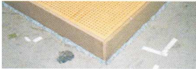
Prüfkörper umlaufend abgedichtet
