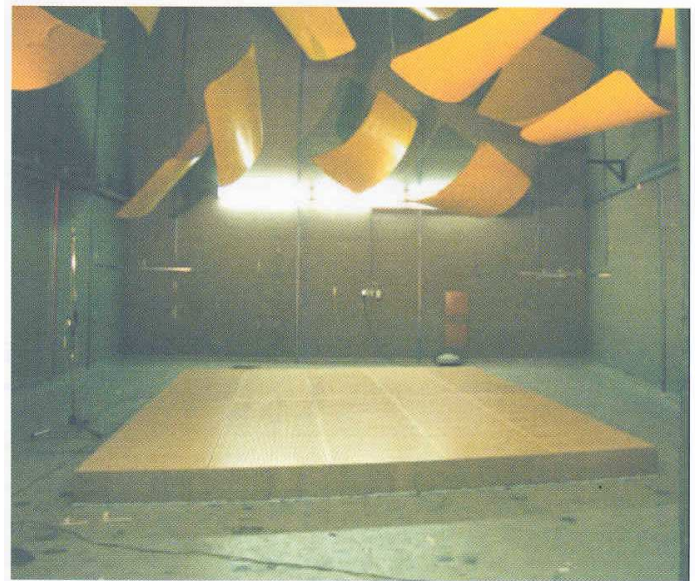
Großer Hallraum am Institut für Bauphysik (IBP) in Stuttgart
