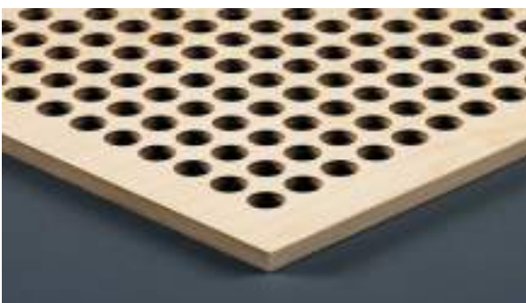
Typ L 12-16, D=12mm, Achsabstand 16mm
