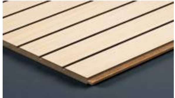
Typ S 3-32 Sichtseite B=3mm Achsabstand 32mm Typ ST 3-32 Sichtseite B=3mm Achsabstand 32mm Rückseite teilweise 8mm zusätzlich ausgefräst
