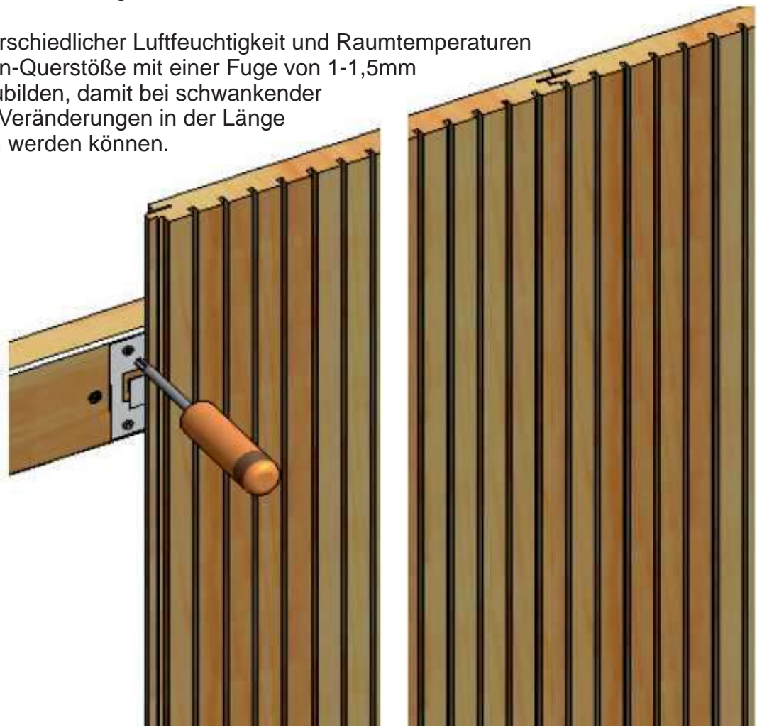
Bild 2: Befestigung mit Schraubkralle
