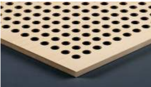
Typ L 10-16 Sichtseite D=10mm Achsabstand 16mm
