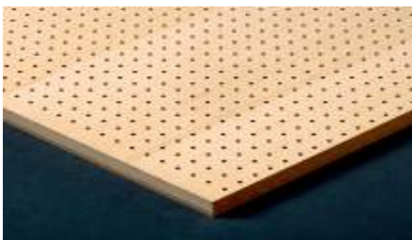
Typ L 2/14-8 Sichtseite D=2mm Achsabstand 8mm Rückseite T-Lochung D=14mm
