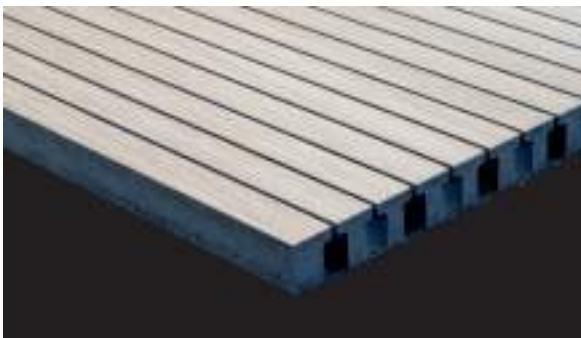
BER Holz F C-DF Akustikplatten Typ SL 3/8-16, S=3mm im Abstand 16mm Rückseite T-Lochung D=8mm Sichtseite Furnier Buche
