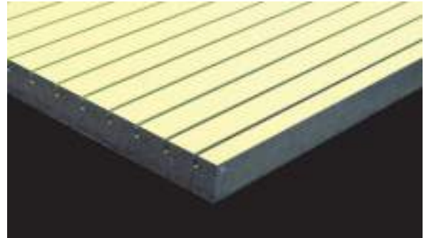
BER Holz F C-DF Akustikplatten Typ SL 2/12-16, S=2mm im Abstand 16mm Rückseite T-Lochung D=12mm Sichtseite Farblackierung im Farbton gelb
