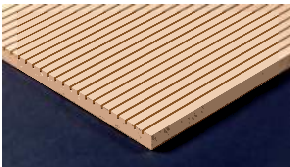
BER Holz F C-MF SL 2/8-16 Akustikplatten Sichtseite S=2mm Achsabstand 16mm Rückseite T-Lochung D=8mm
