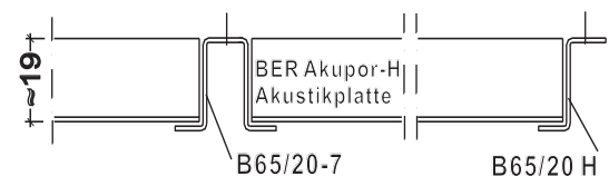
Schnitt-Schema Unterkonstruktion nach Prüfzeugnis
