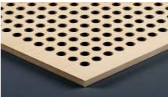
Typ L 10-16, D=10mm, Achsabstand 16mm
