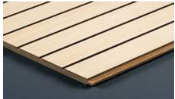
Typ ST 4-32 Sichtseite B=4mm Achsabstand 32mm Rückseite teilweise 8mm zusätzlich ausgefräst
