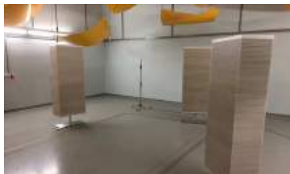
Foto: Anordnung der Elemente im Hallraum, Fraunhofer Institut für Bauphysik, Stuttgart
