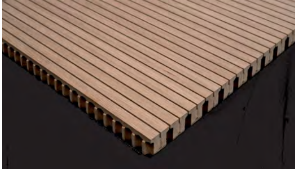
Typ SL 2/8-16 Sichtseite B=2mm Achsabstand 16mm Rückseite T-Lochung D=8mm Typ SL 2/12-16 Sichtseite B=2mm Achsabstand 16mm Rückseite T-Lochung D=12mm
